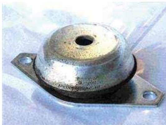
Supporti che consentono un alto livello di isolamento, in particolare utilizzati su gruppi elettrogeni, motori ed impianti con frequenza di lavoro intorno ai 25 HZ (1.500 rpm). Le sollecitazioni assiali sono ottimamente assorbite e le deflessioni laterali limitate (con carico a taglio max 30%) per garantire una buona stabilità.
